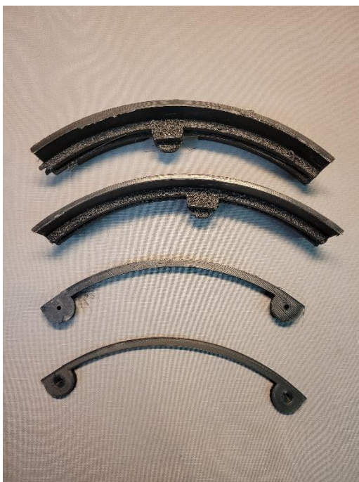
Assemblage du pare choc avant par collage de 4 pièces
