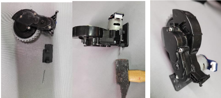
Montage du nouveau support moteur avec la goupille
